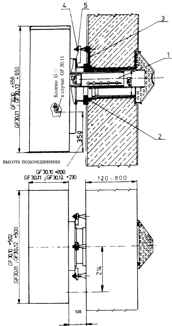
Рис. 3. Монтаж установки с закрытой камерой сгорания
